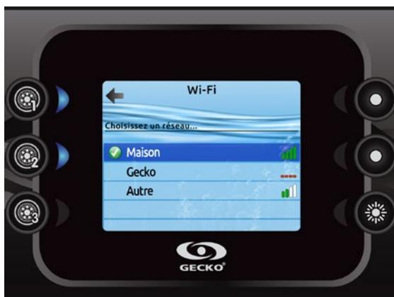
Lorsque le module in.touch est connecté à un réseau WiFi, un crochet vert apparait dans le menu Wi-Fi et le nom du réseau est affiché dans le menu *Réglages*.
